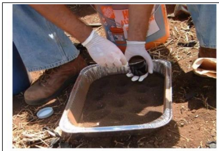
Figura 4 – Formação da amostra composta para determinação analítica
