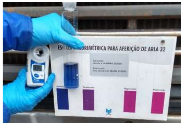
Fotografia 4 – Coleta de amostra e registro de resultado após avaliação de ARLA32
