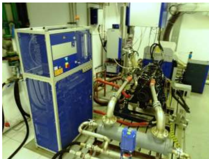
Fotografia 8 - Laboratório de emissão veicular de São Bernardo do Campo: Dinamômetro de bancada
