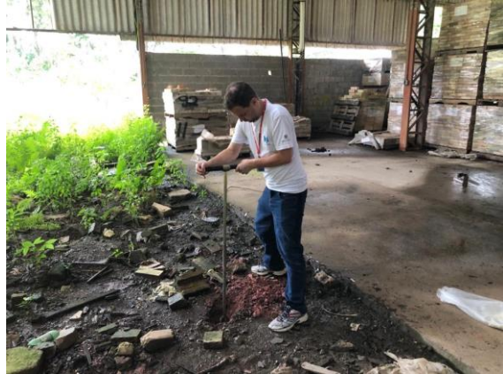
Figura 64 – Realização de amostragem em área acessível do solo no interior do galpão do Brownfield (P-02), a jusante do local onde foram observados recipientes contendo produtos químicos ou resíduos.
