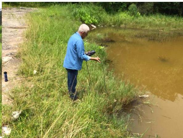
Figura 70 – Realização de monitoramento em lagoa presente no Brownfield fazendo uso de sonda multiparâmetros.
