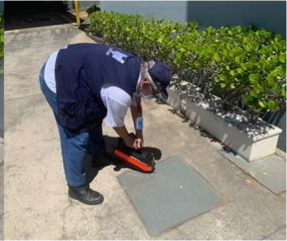
Figura 25 - Monitoramento na caixa de esgoto do empreendimento suspeita de contaminação por tintas e vernizes utilizando GDA.
