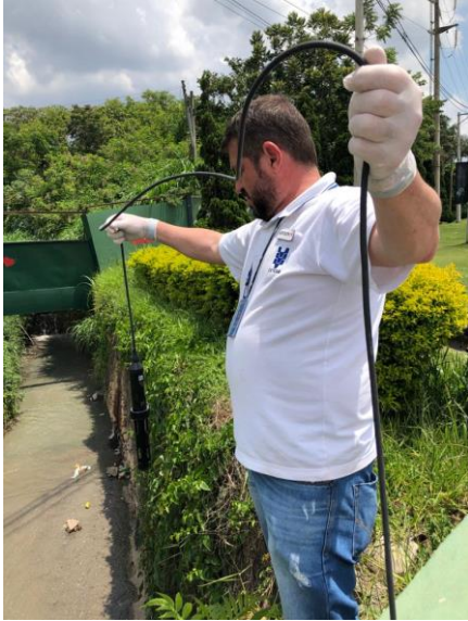
Figura 37 – Monitoramento com sonda multiparâmetros no córrego Poá, 370 m a jusante do empreendimento.
