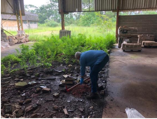
Figura 63 – Realização de amostragem em área acessível do solo no interior do galpão do Brownfield (P-02), a jusante do local onde foram observados recipientes contendo produtos químicos ou resíduos.
