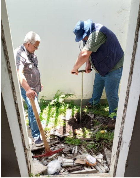
Figura 46 - Obtenção de amostra no Ponto 1 do empreendimento, montante do local onde ocorria a produção, armazenamento e manipulação de matéria prima e produtos.
