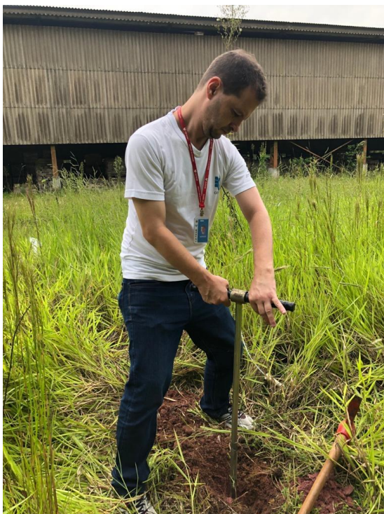
Figura 61 – Perfuração com trado no P-01 do Brownfield, a montante do local onde foram observados recipientes contendo produtos químicos ou resíduos.
