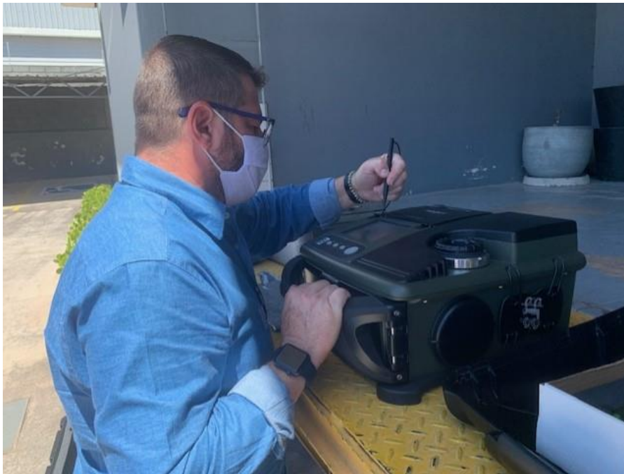
Figura 26 - Injeção de amostra obtida da caixa de esgoto do empreendimento em equipamento de GC/MS portátil.
