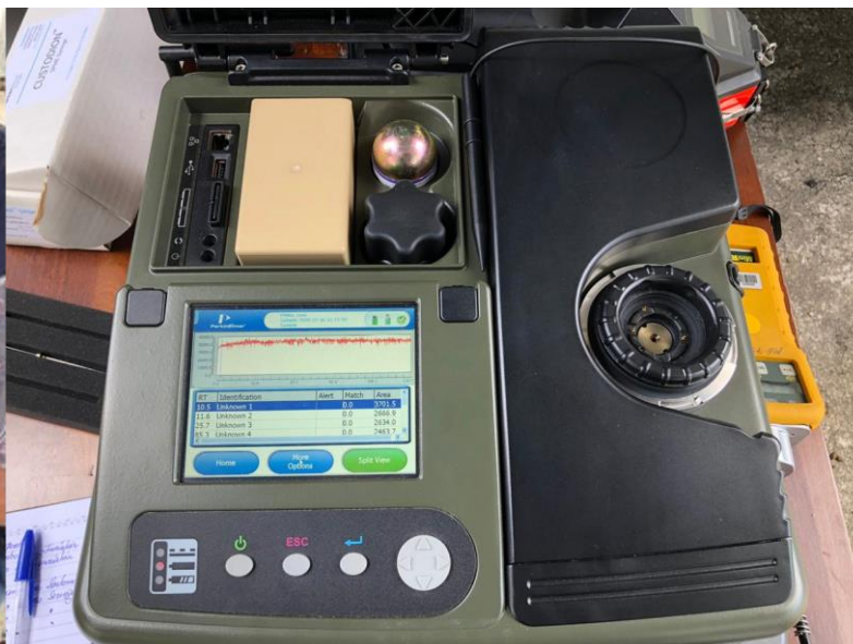
Figura 51 – Injeção de amostras obtidas na área onde se localizava o empreendimento no equipamento GC/MS.
