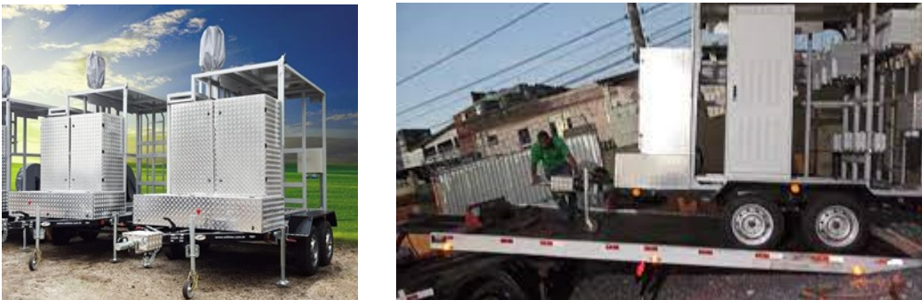
Imagens 6 e 7 - Equipamentos de uma ERB Móvel montado sobre reboque
