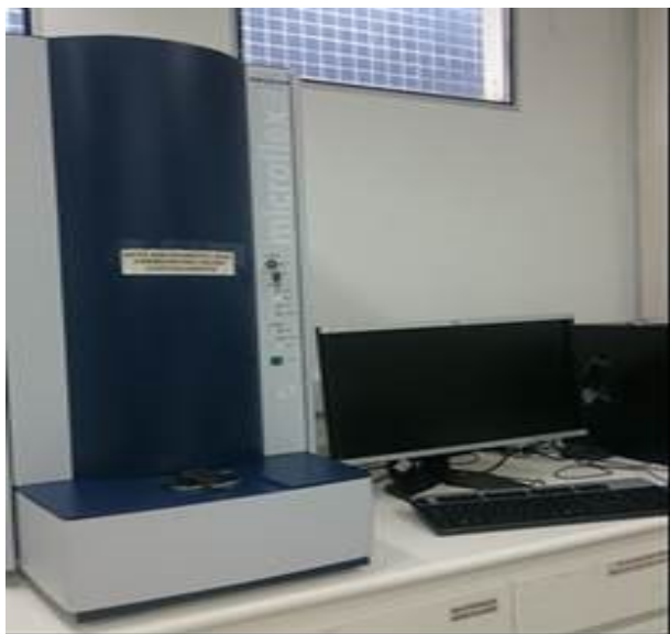
Figura 7. Espectrômetro de Massas do Tipo MALDI-TOF ( Matrix-Assisted Laser Desorption/Ionization Time-of-Flight Mass Spectrometry ), Modelo Microflex, Marca Bruker-Daltonics® (Patrimônio CETESB ME-11706).
