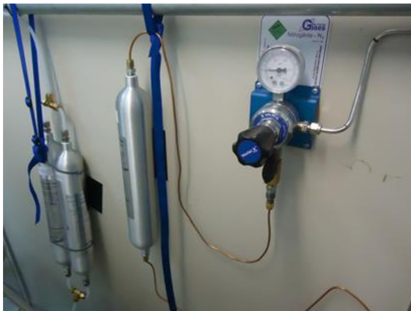
Foto 2. Linhas de gases que alimentam o LC-MS/MS.
