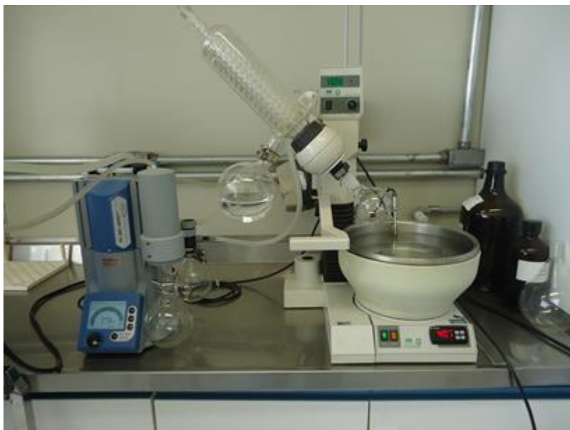
Foto 4. Rotavapor empregado na preparativa das amostras para análise dos agrotóxicos.
