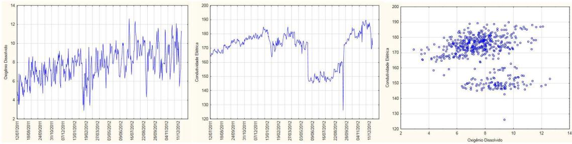
**Figura 4.** Série temporal das médias diárias para os Oxigênio Dissolvido (esquerda) e Condutividade Elétrica (centro), no período de 12/07/2011 a 20/12/2012, e o gráfico de dispersão para este par de parâmetros (direita)
