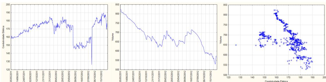
**Figura 7.** Série temporal das médias diárias para os Condutividade Elétrica (esquerda) e Volume (centro), no período de 05/05/2011 a 20/12/2012, e o gráfico de dispersão para este par de parâmetros (direita).
