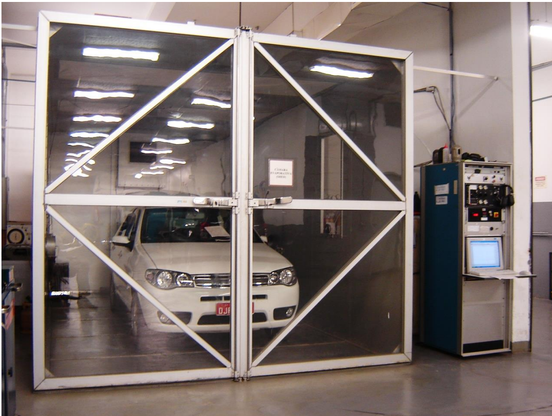
Figura 5 - Veículo inserido para ensaio de emissão evaporativa na câmara SHED do laboratório de Emissão Veicular da CETESB em São Paulo
