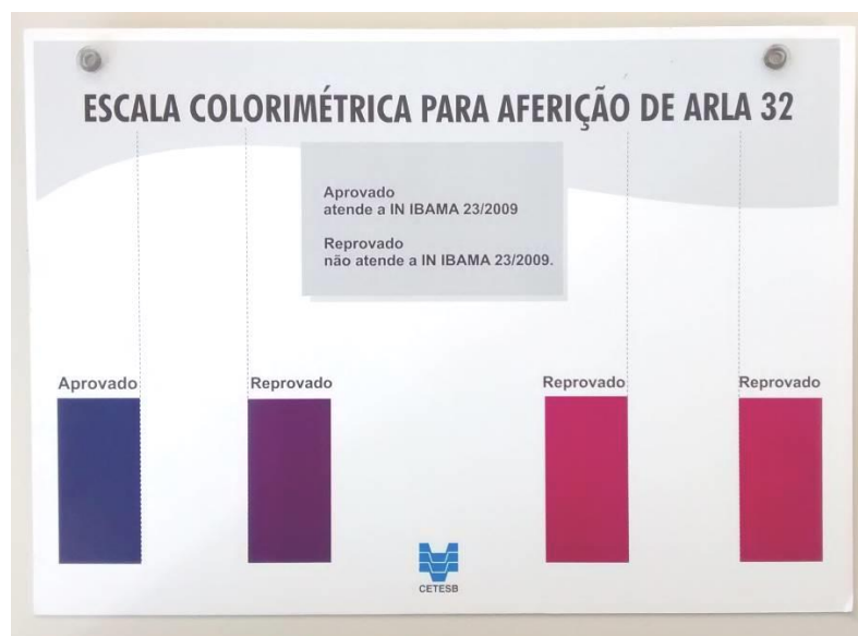
Figura 3 - Escala Colorimétrica para aferição de ARLA 32
