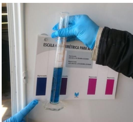
Figura 4 – Análise da qualidade da água do ARLA 32 utilizando a escala colorimétrica
