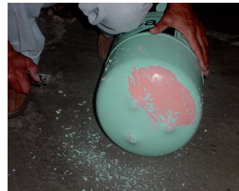
Figura 5: Cilindro de CFC 12 pintado com a cor de identificação do fluido HFC-134a (Fonte: IBAMA, 2005)
