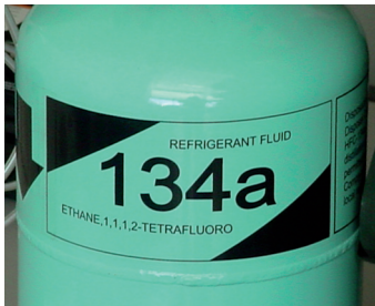
Figura 3: Cilindro aparentemente contendo HFC - 134a (Fonte: IBAMA, 2005)
