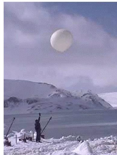
As fotos ilustram o momento do lançamento do balão. O sensor de ozônio vai anexado dentro de uma caixa de isopor para proteção durante o vôo.
