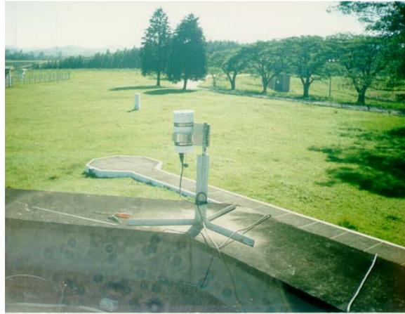
A foto à esquerda ilustra o sensor de UV. No topo da parte branca tem uma janela de acrílico especial por onde passa a radiação solar. Para a coleta das medidas um micro computador gerencia a operação e grava os dados que serão analisados posteriormente. A foto da direita mostra o GUV Operando em Cachoeira Paulista.
