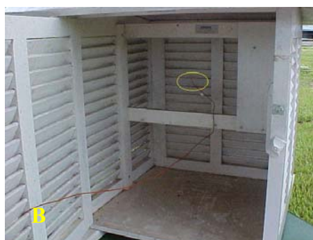
Figura 13. Detalhes dos sensores de temperatura instalados no interior do gasômetro (A) e do abrigo meteorológico (B).
