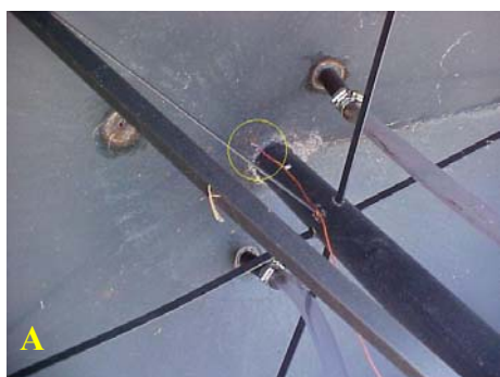
Figura 13. Detalhes dos sensores de temperatura instalados no interior do gasômetro (A) e do abrigo meteorológico (B).
