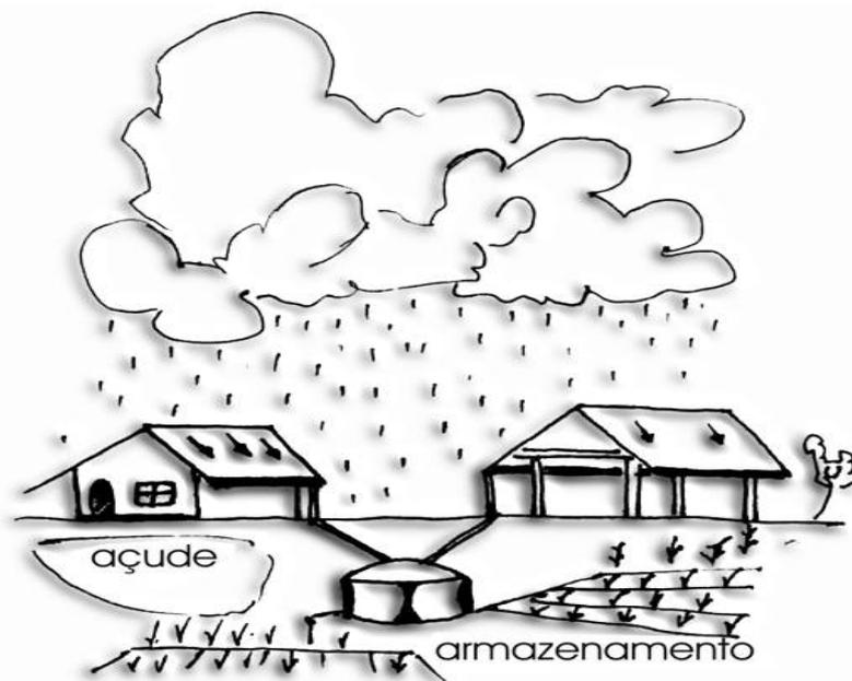
Figura 4.18 – Coleta e armazenamento de água.
