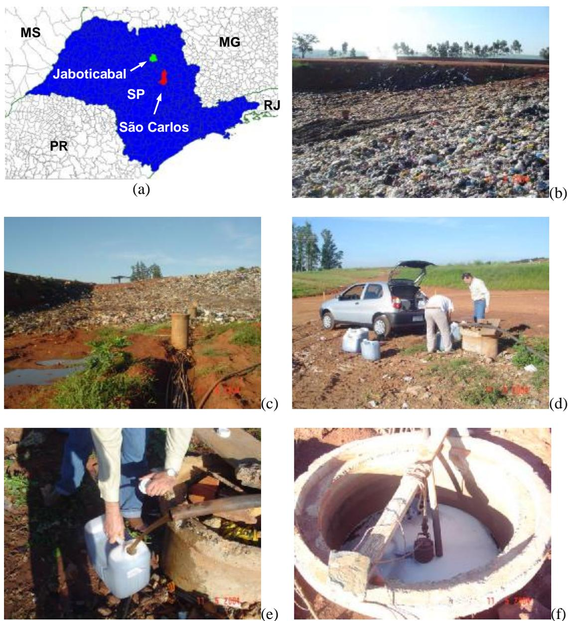
Figura 4.3. (a) Localização geográfica de Jaboticabal (SP). (b) e (c) Aspecto do aterro sanitário. (d) e (e) Coleta do lixiviado no poço de infiltração. (f) Poço coletor de lixiviado.
