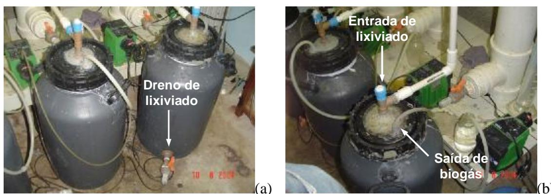
Figura 4.6. (a) Dreno de lixiviado no reator de fase sólida. (b) Entrada de lixiviado tratado no reator e saída de biogás.
