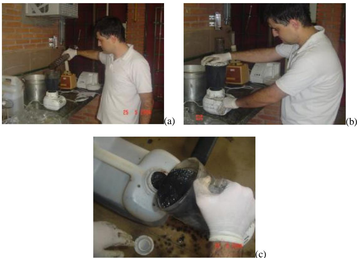
Figura 4.5. (a) Adição de 500 mL de lixiviado ao recipiente. (b) Agitação de 1 L de mistura. (c) Armazenamento de 1 L de inóculo.
