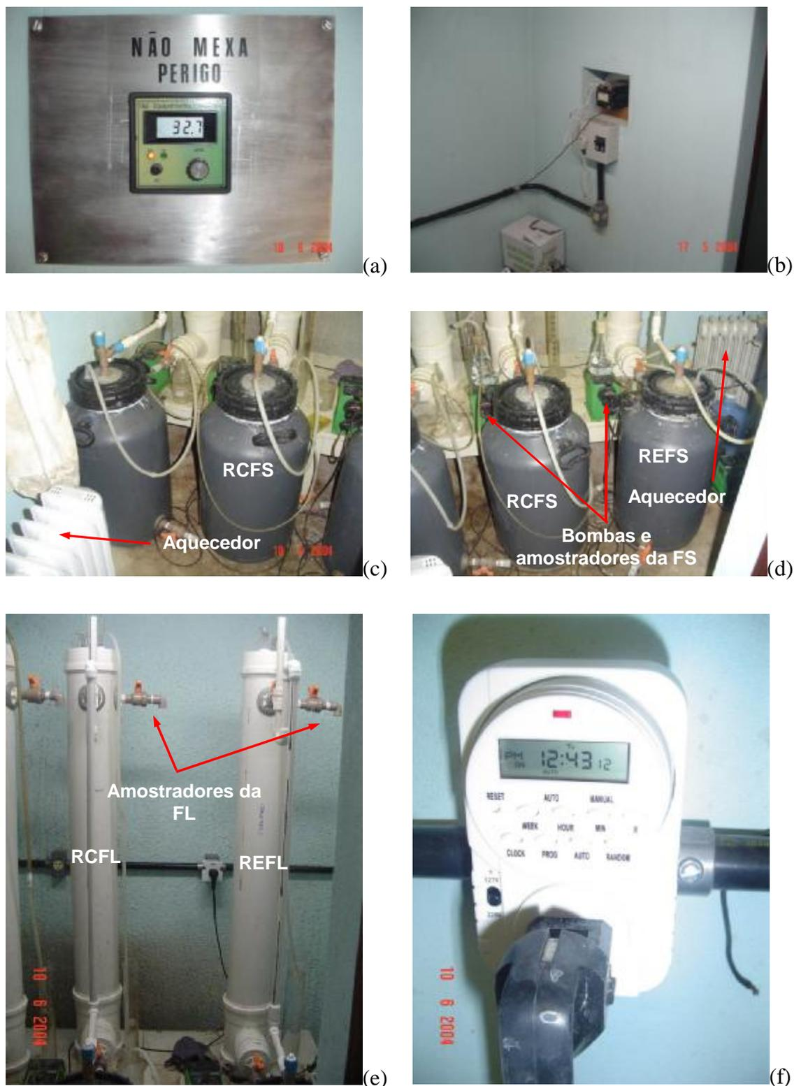
Figura 4.10. (a) Visor do termostato indicando a temperatura no interior da câmara. (b) Instalação elétrica do termostato. (c) e (d) Localização dos aquecedores e das bombas no interior da câmara. (e) Os dois reatores de fase líquida em funcionamento. (f) Temporizador para funcionamento da bomba.
