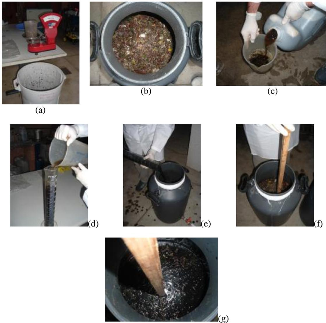
Figura 4.8. (a) Pesagem da FOPRSU. (b) Abastecimento do reator com FOPRSU. (c) Passagem do inóculo do recipiente de 20 L para béquer de 2 L. (d) Medição do volume de inóculo em proveta de 1 L. (e) Abastecimento do reator com inóculo. (f) Agitação do meio de reação após adição de inóculo. (g) Aspecto do meio de reação após inoculação.
