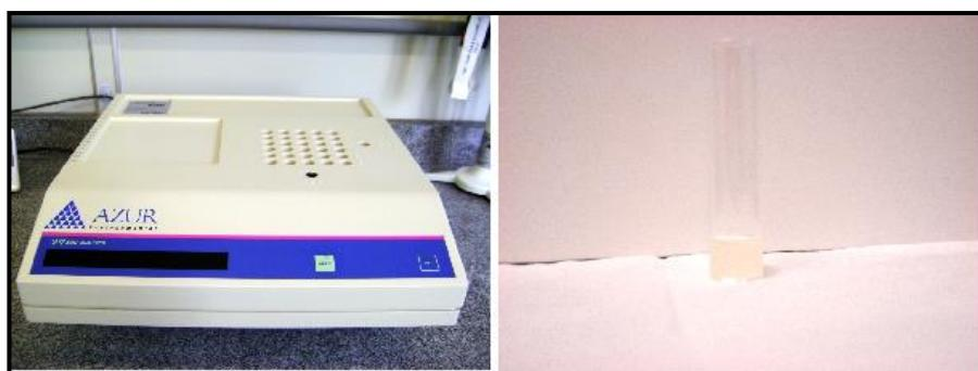
Figura 2 – Sistema analisador de toxicidade e cubeta de vidro
