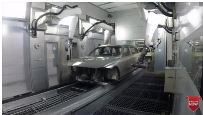
Figura 19 - Aplicação do primer de superfície sobre a carroceria automotiva
