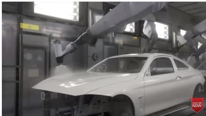
Figura 21 - Aplicação do verniz transparente feita por robôs
