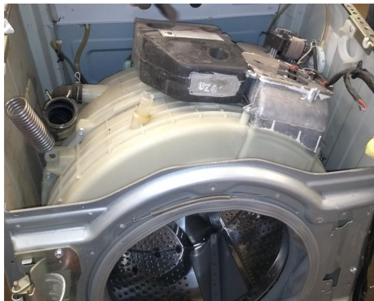
Figura 14. Bloco de concreto na máquina de lavar
