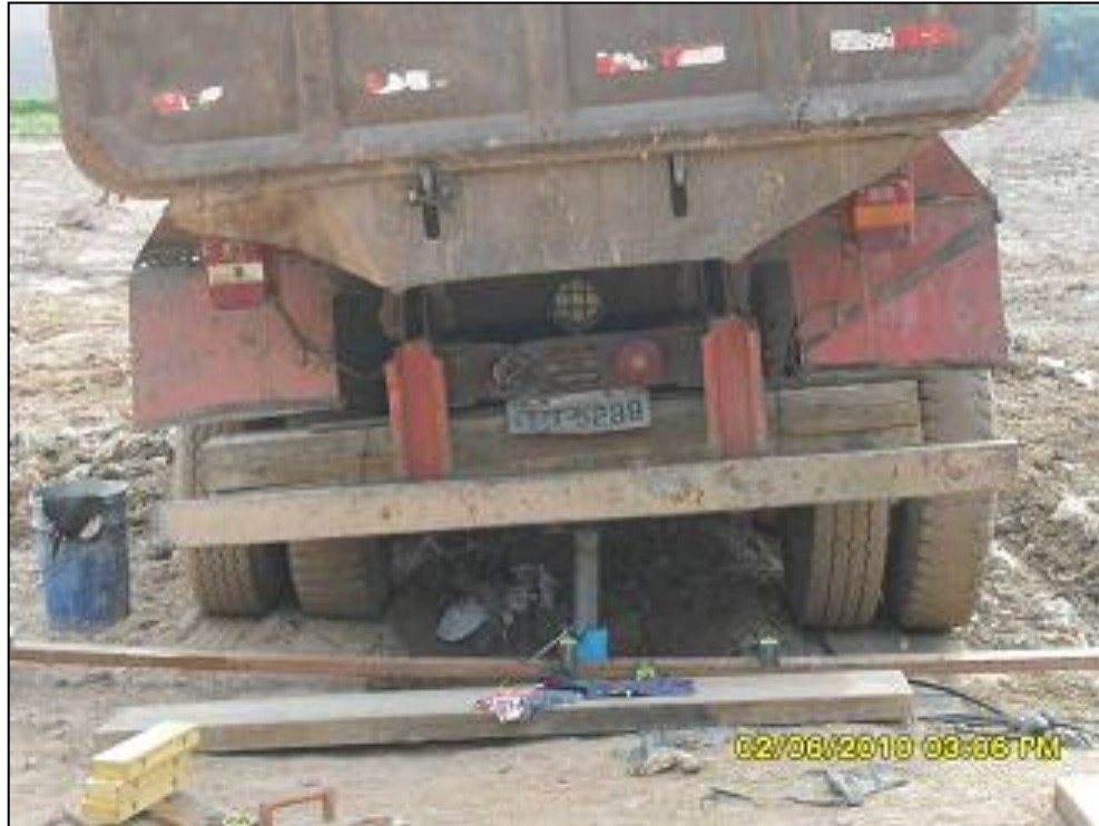
Figura 4.14 – Efeitos do recalque diferencial da placa no caminhão
