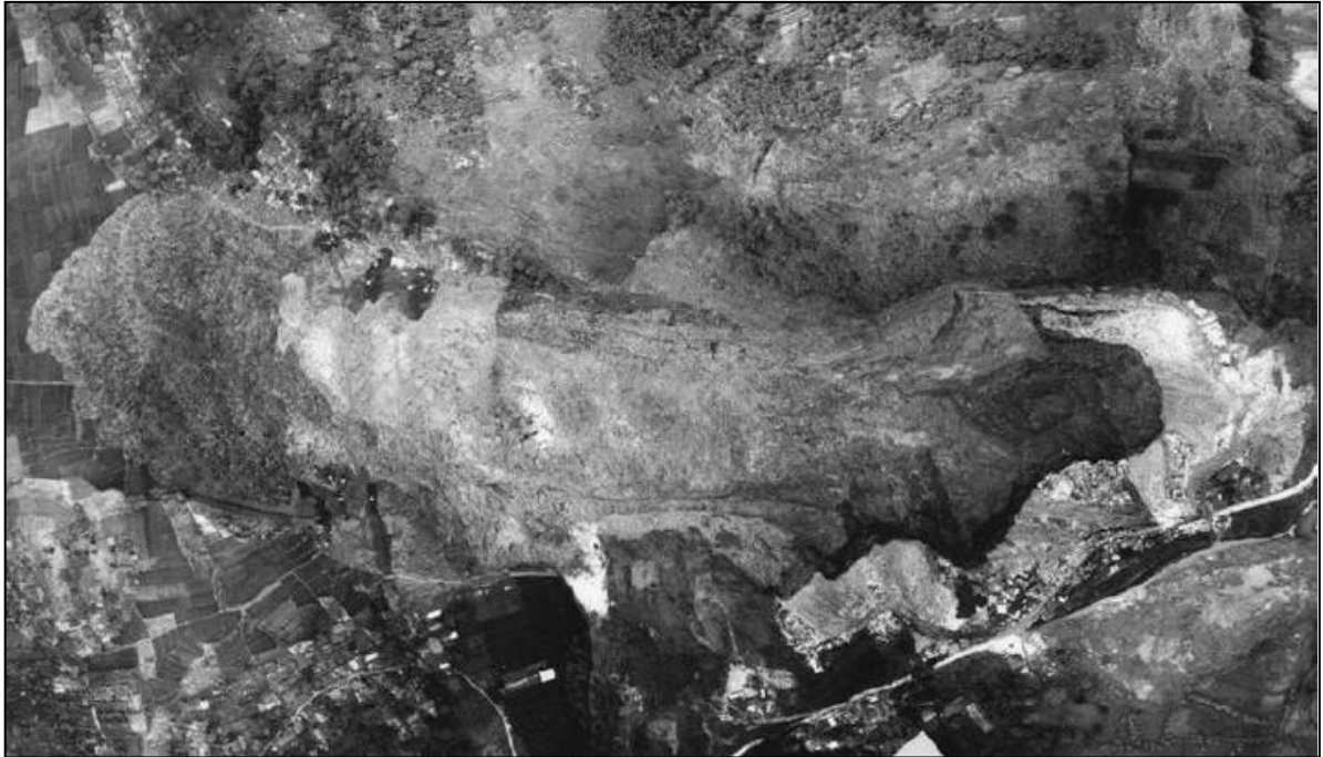
Figura 3.2 - Imagem de satélite do aterro de Leuwigajah após a ruptura (KÖLSCH et al., 2005)
