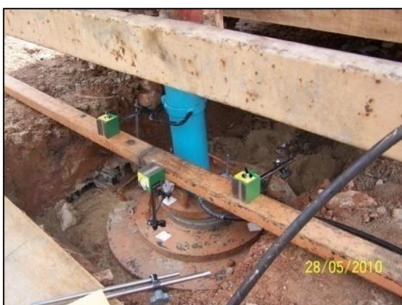
Figura 4.12 - Posicionamento dos extensômetros
