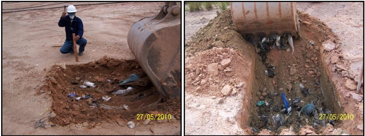
Figura 4.3 - Investigação preliminar das regiões aptas para se realizar os ensaios de placa.
