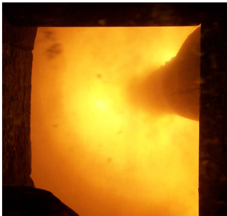
Figura 4.1 – Vista parcial da zona de queima primária de um forno de clínquer com resfriador de satélites
