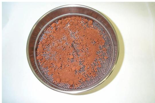
Figura 28 – Peneiramento da amostra de solo.
