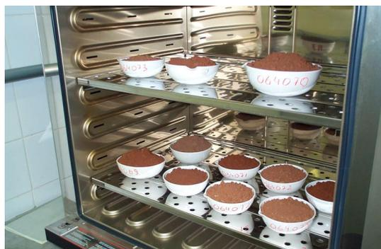
Figura 24 – Secagem das amostras de solos a  $40 \pm 2$  °C em estufa.
