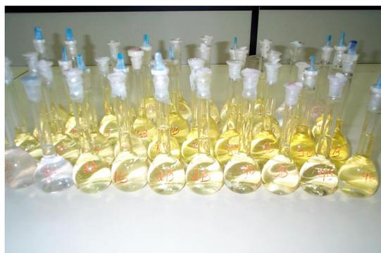
Figura 32 - Apresentação das amostras dos solos deste experimento após a digestão em forno de microondas, utilizando-se somente ácido nítrico em digestão assistida por microondas.
