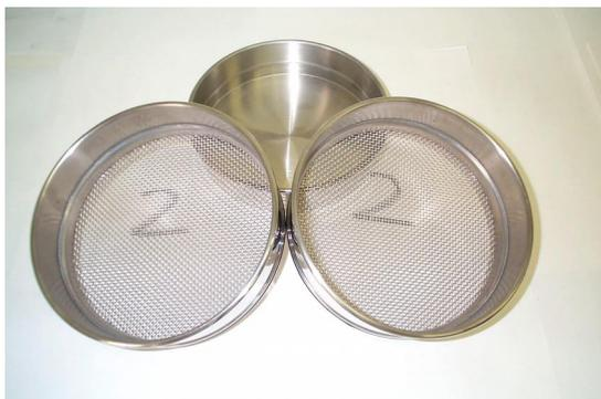
Figura 27 - Peneiras de aço inox com malha de 2,0 mm.
