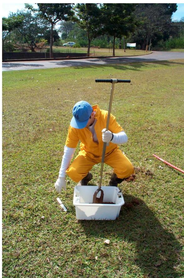
Figura 18 – Colocação das amostras coletas em caixa plástica.
