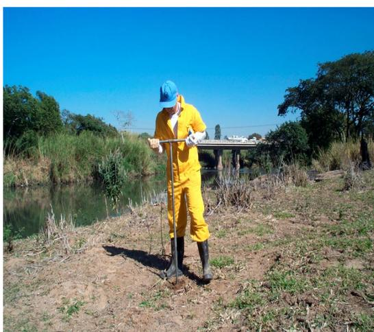
Figura 17 - Utilização de trado para coletar as amostras de solo com profundidade de 20 cm.
