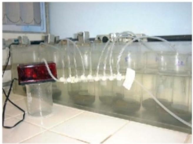
FIGURA 3 - Vista parcial da montagem experimental do teste de toxicidade na interface sedimento/água.
