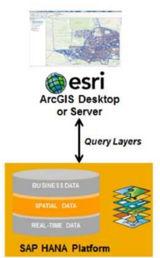
Imagem 8: Conexão entre os sistemas ArcGIS (ESRI) e SAP HANA via Query Layers.
