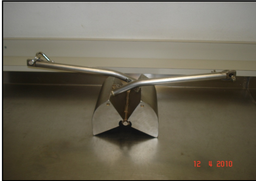
FIGURA 3.13 – Pegador van Veen montado para coleta de sedimento, com o sistema travado
