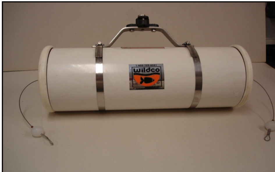
FIGURA 3.11 – Garrafa fechada, pronta para ser puxada para a superfície
