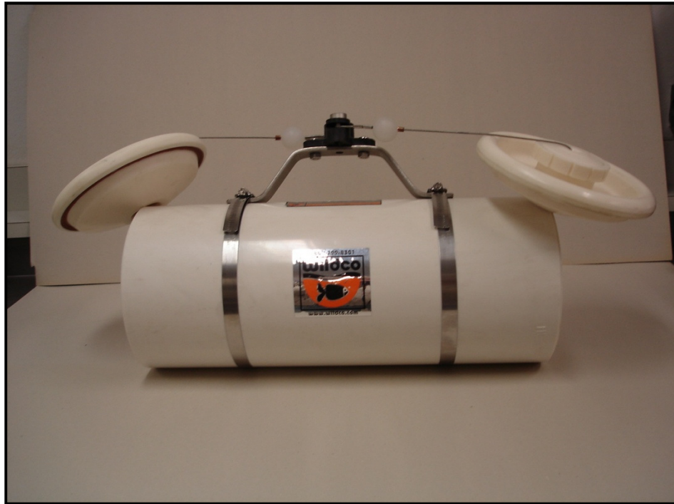
FIGURA 3.10 - Garrafa montada pronta para o lançamento em água
