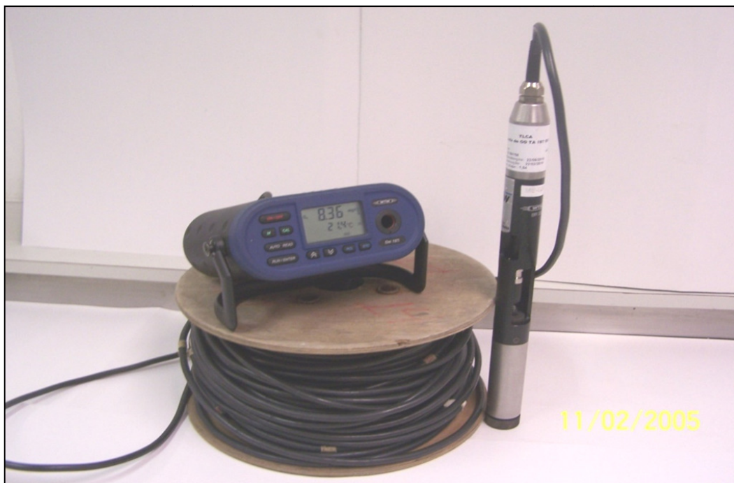
FIGURA 3.15 – Oxímetro com sonda de OD e eletrodo conectado ao agitador magnético (em pé)
