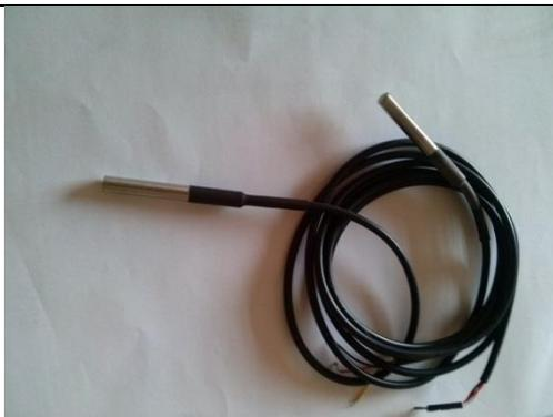
Figura 3.4 – Sensores Digitais de temperaturas DS18B20
