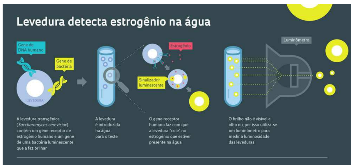
Figura 9 – Processos de expressão e detecção de luminescência do teste BLYES (VASCONCELOS, 2012).
