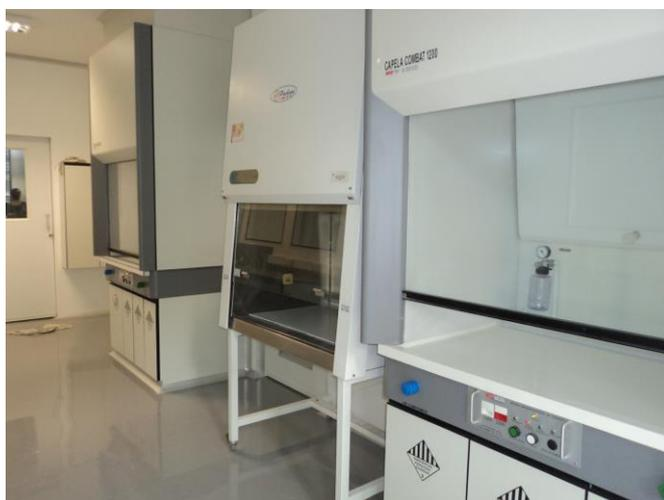
**Figura 34.** Sala de Preparo - capelas químicas, fluxo laminar e solventes. Fonte: Setor de Engenharia, CETESB
