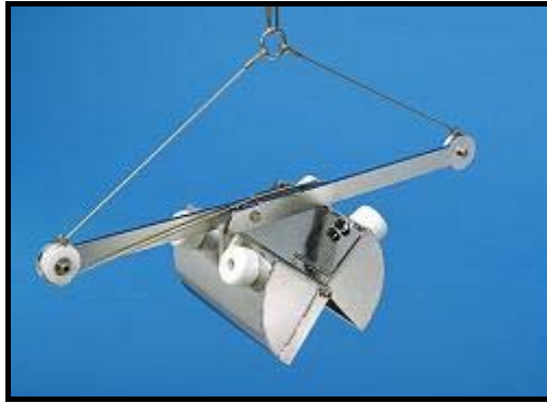
Figura 10: Amostrador van Veen (KC, 2006)
