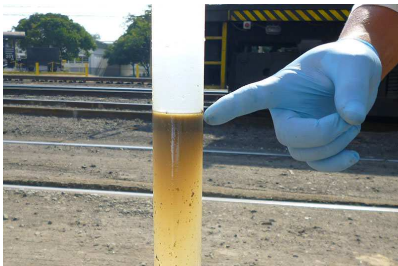
Figura 2: Fase livre existente em água subterrânea após contaminação por vazamento de combustível.
