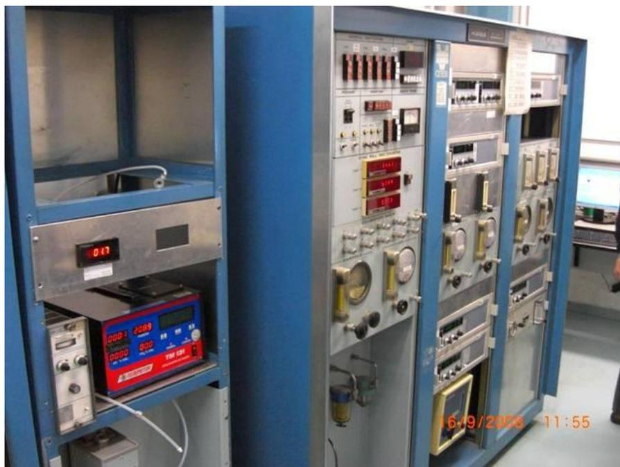
Figura 36: Foto dos novos analisadores de gases utilizados nos ensaios do veículo FOX (ciclo Otto).
