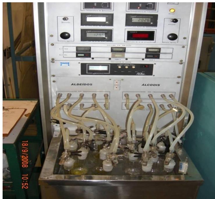
Figura 31: Foto do sistema de coleta de aldeídos e álcool
