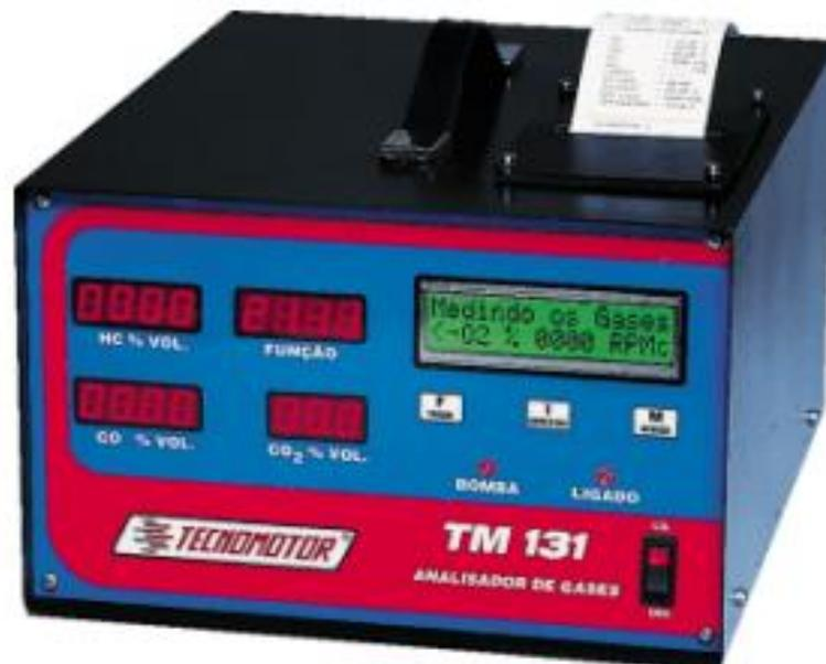
Figura 38 Foto do analisador de gases por infravermelho utilizado nos ensaios do veículo JUMPER
