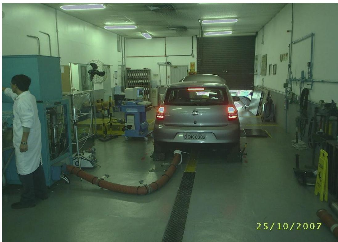
**Figura 21: Foto do ensaio realizado no veículo FOX sem o conversor catalítico**
