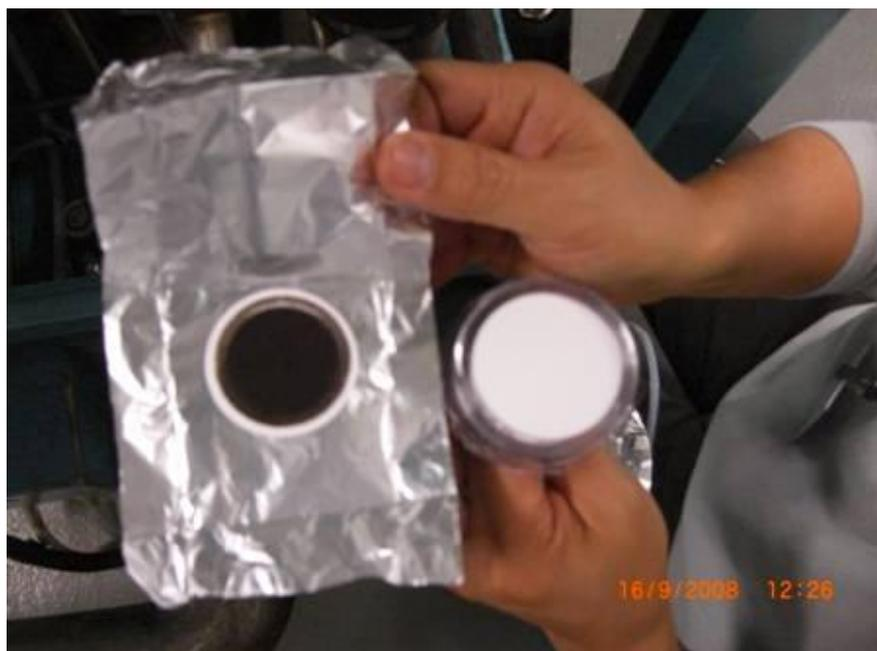
Figura 28: Foto do filtro retirado após a realização da coleta de aldeídos
