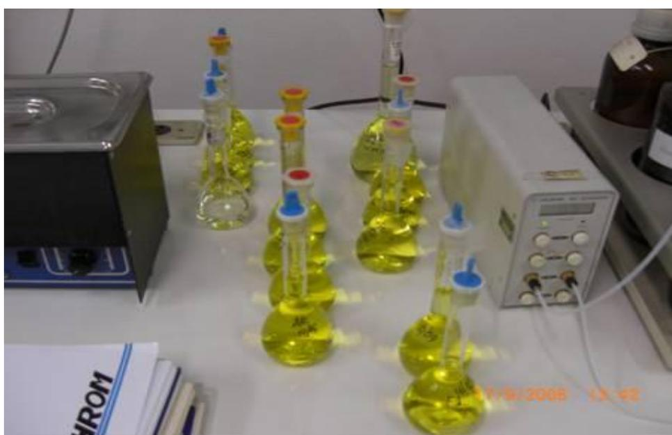
Figura 33: Foto dos balões de 100 ml identificados e avolumados com acetonitrila.
