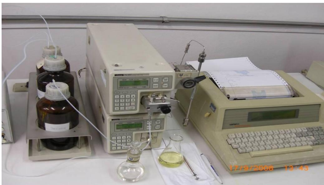
Figura 34: Foto do cromatógrafo líquido de alto desempenho – CLAD e do integrador utilizados nos ensaios.
