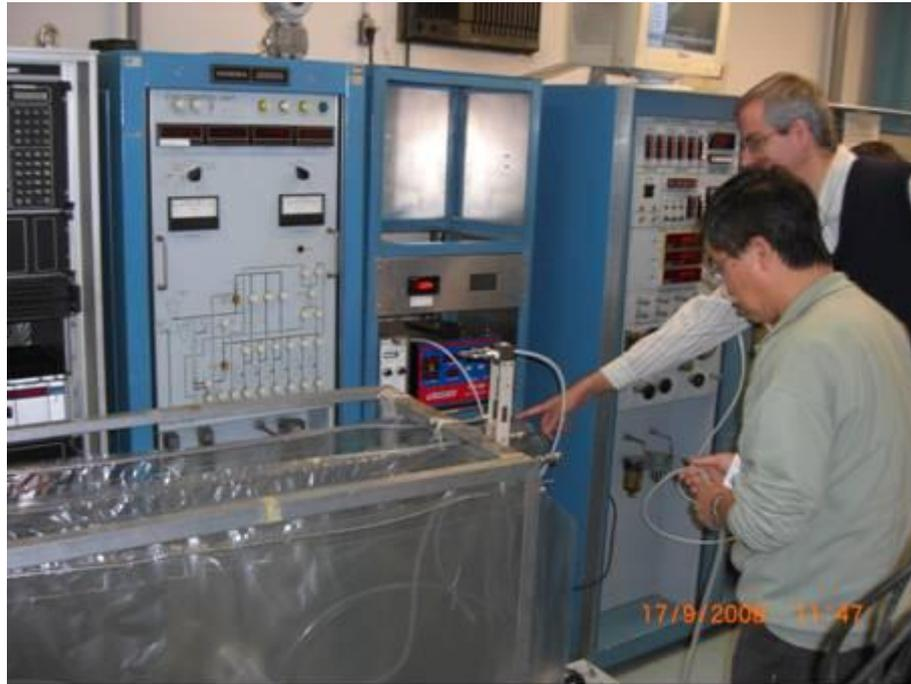
Figura 37: Foto do analisador de gases utilizado nos ensaios do veículo JUMPER (ciclo Diesel)
