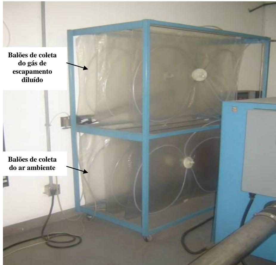
Figura 16: Foto do conjunto de balões de coleta para o gás de escapamento diluído e o ar ambiente
