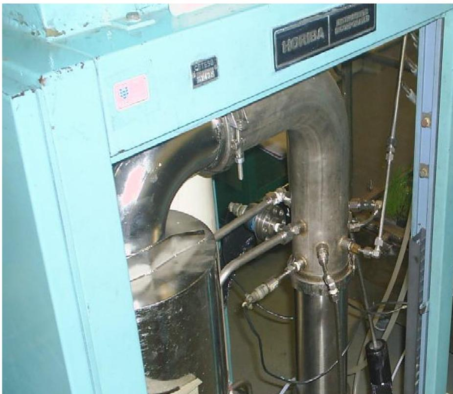
Figura 15: Foto do Amostrador de Volume Constante - AVC - detalhe
