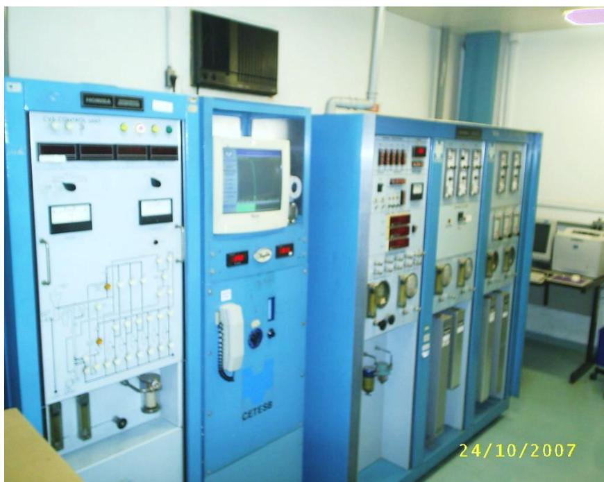
Figura 35: Foto dos antigos analisadores de gases utilizados nos ensaios do veículo FOX (ciclo Otto).
