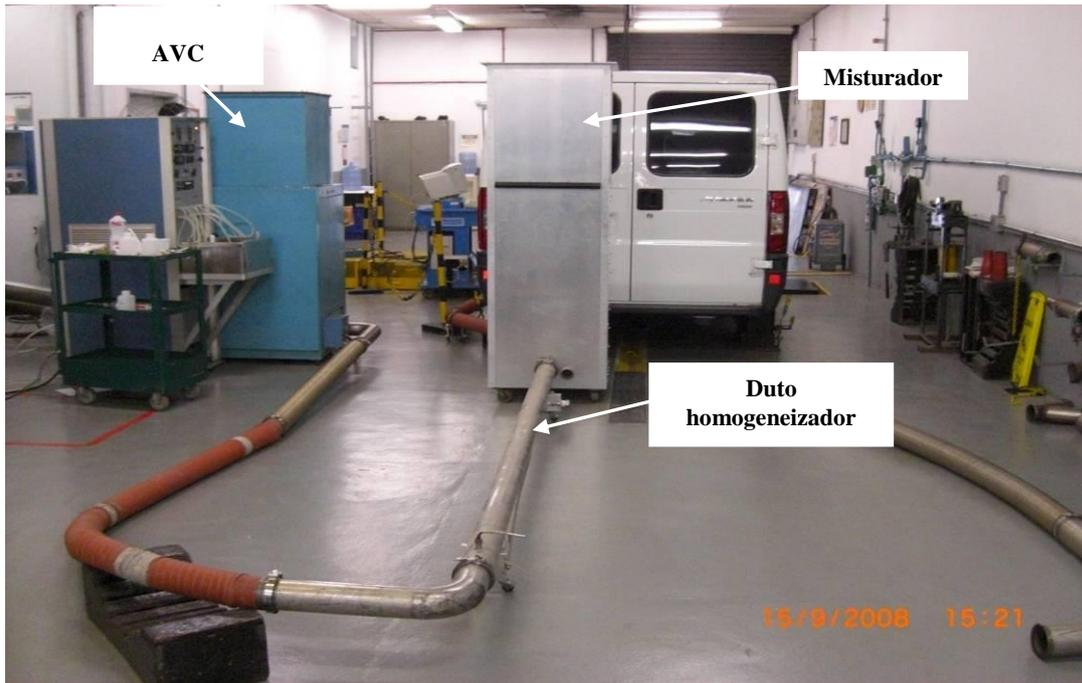
Figura 24: Foto do ensaio realizado no veículo JUMPER após a instalação do misturador e duto homogeneizador.
