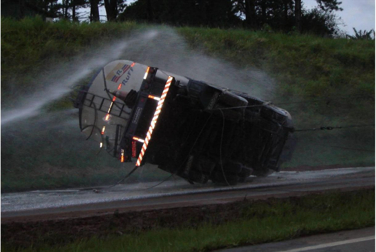
Figura 10 - Foto de Operação de destombamento, com aspersão de água para evitar incêndio/explosão.
