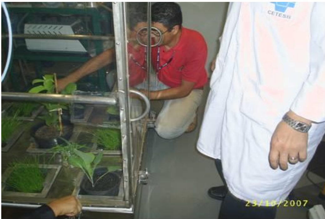
Montagem do equipamento utilizado para exposição das plantas aos gases provenientes do veículo ensaiado.
