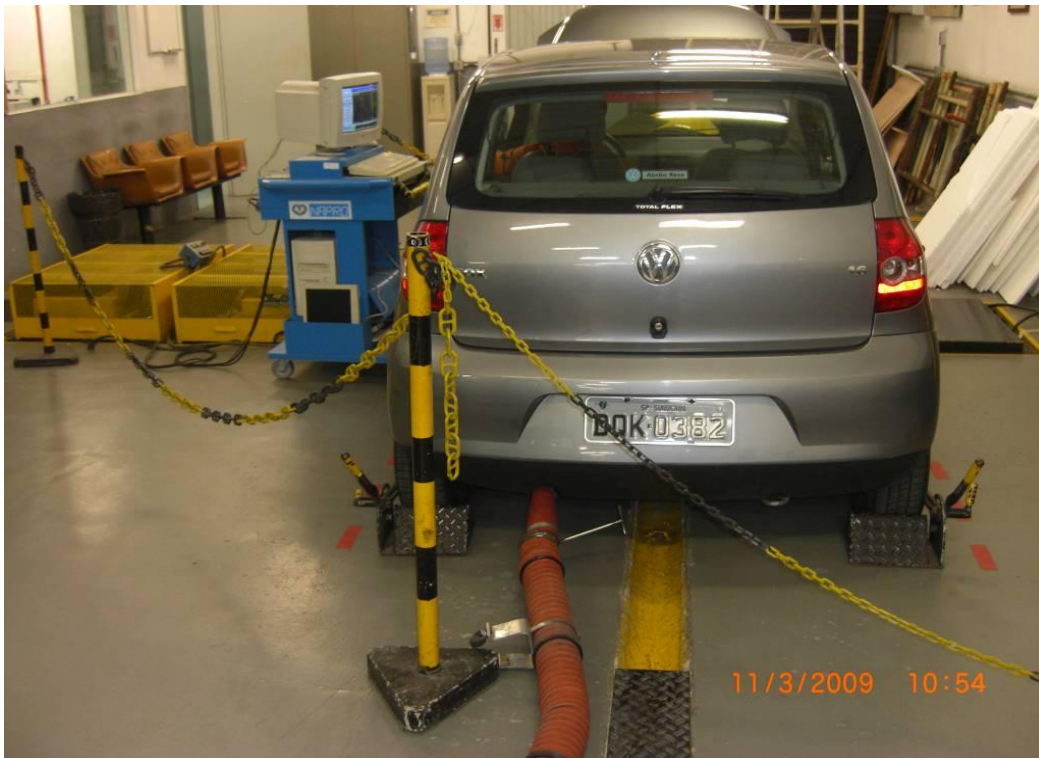
Detalhe: veículo ciclo Otto, modelo Fox 1.6 tipo flex durante ciclo FTP, com catalisador.
