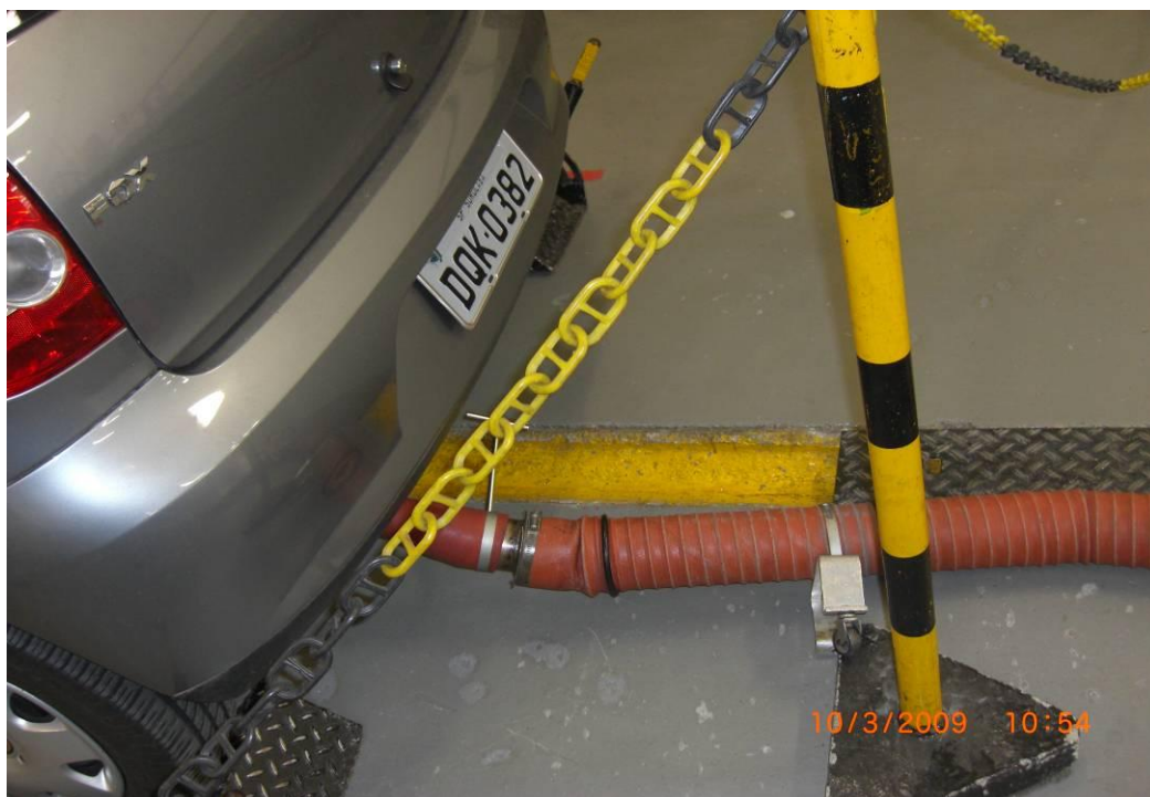
Detalhe: veículo ciclo Otto, modelo Fox 1.6 tipo flex durante ciclo FTP, com catalisador.
