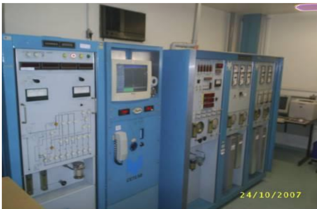
Sala de análise do laboratório de veículos da CETESB, detalhe dos analisadores em 2007.
