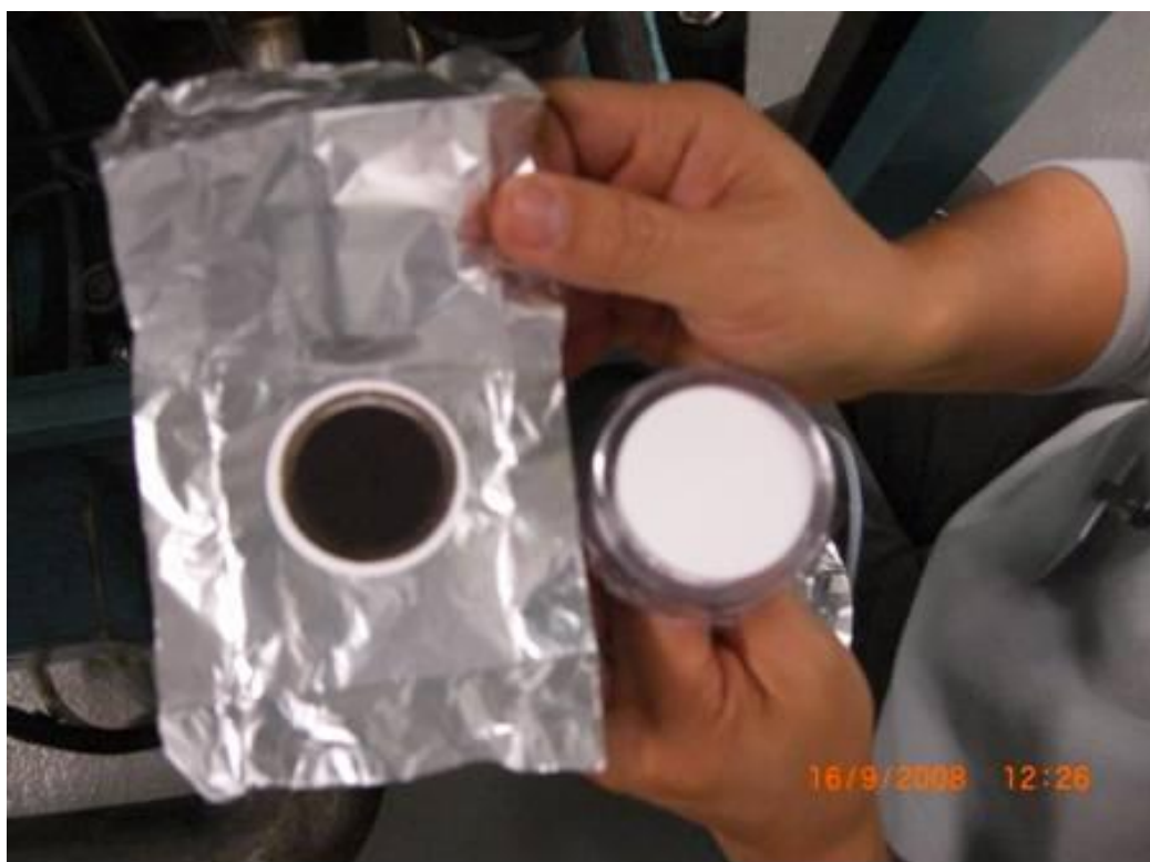
Filtros para coleta e análise de material particulado, após experimento com Diesel Metropolitano B2.
