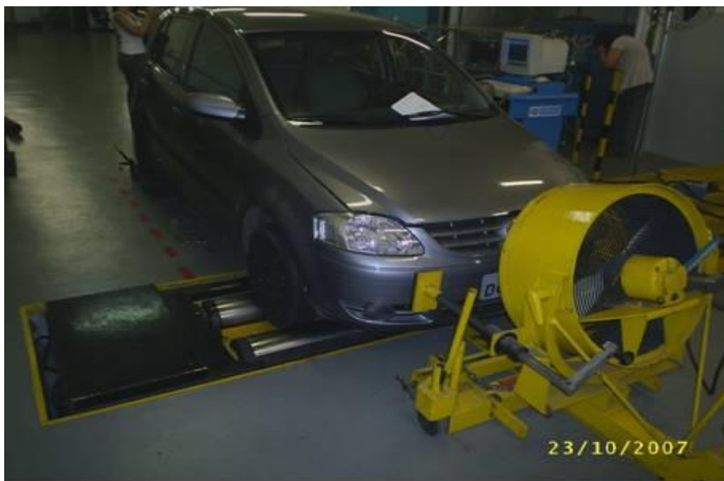
Detalhe: veículo ciclo Otto, modelo Fox 1.6 tipo flex no Dinamômetro de Chassi.
