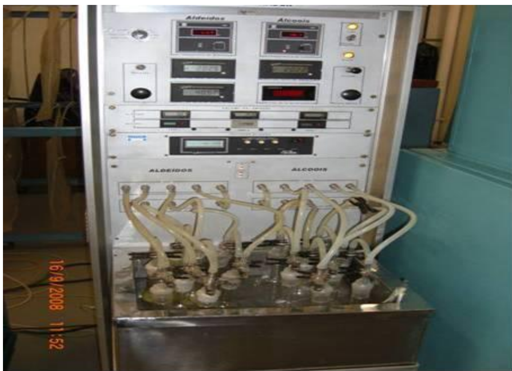
Equipamento utilizado para coleta de aldeídos do laboratório de veículos da CETESB.
