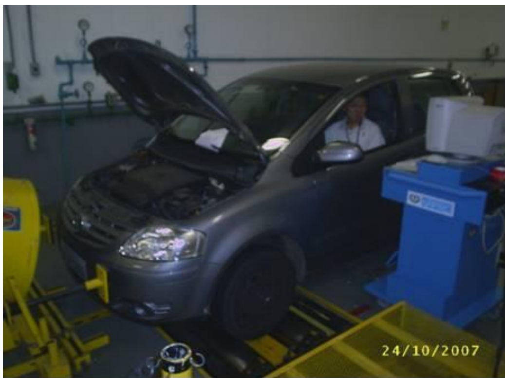
Detalhe: veículo ciclo Otto, modelo Fox 1.6 tipo flex durante ciclo FTP, sem catalisador.
