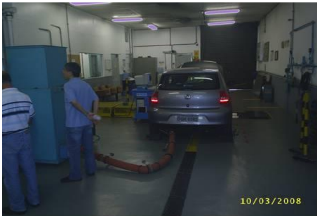
Detalhe: veículo ciclo Otto, modelo Fox 1.6 tipo flex durante ciclo FTP, sem catalisador.
