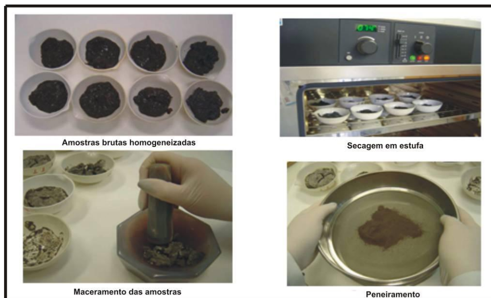
Figura 3.15 – Preparo de amostra de sedimento (QUINÁGLIA, 2006)
