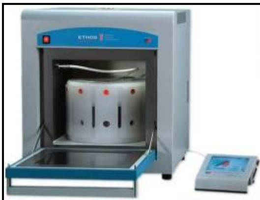
Figura 3.17 – Digestor por micro-ondas (figura cedida por Gilson A. Quinágua)
