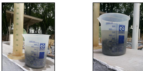
Figura 20. Teste de vazios com água para as britas Nº 1 e Nº 2
