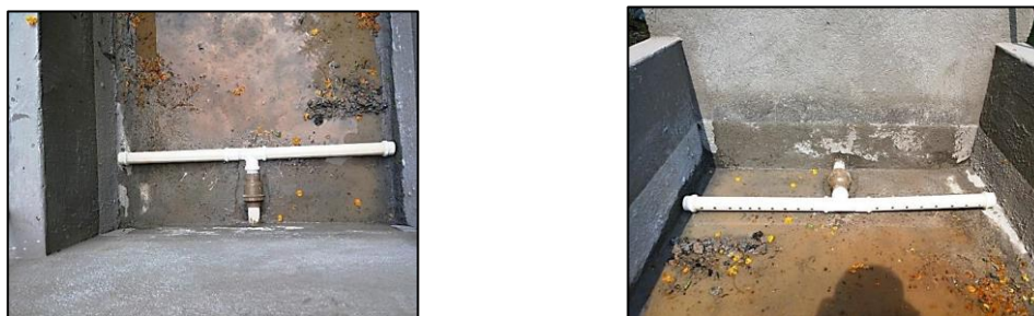
Figura 14. Vistas superior e frontal do sistema de alimentação da câmara de fluxo horizontal
