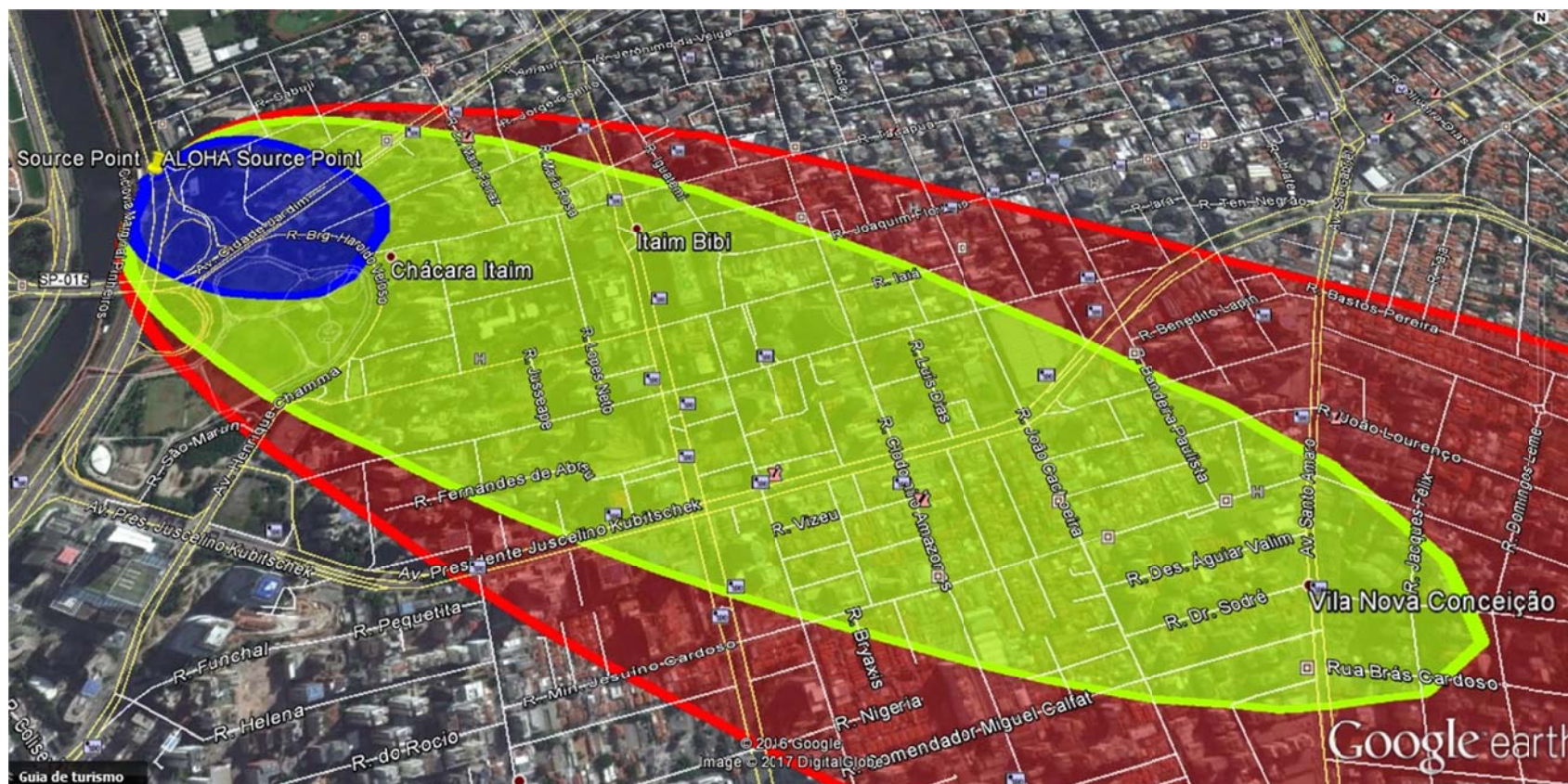
Figura 9. Detalhes da área com possibilidade de intoxicação das pessoas expostas e prejudicial à habilidade de escapar (contorno verde, distância alcançada de 2.300 metros, representando a concentração AEGL - 2).
