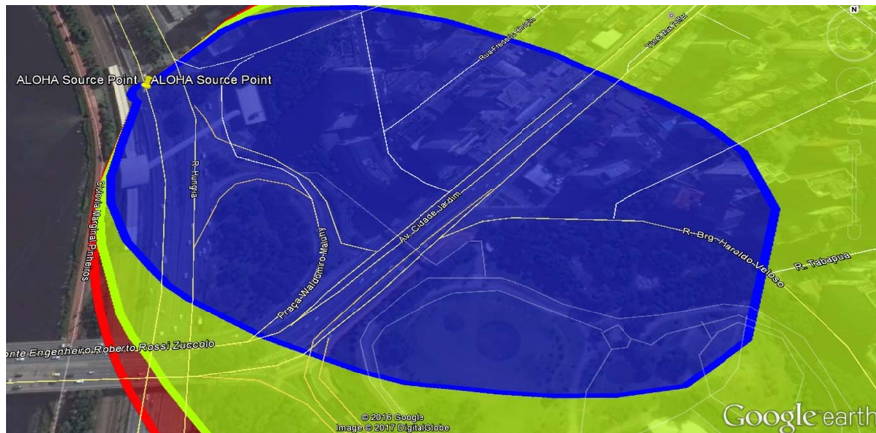
Figura 8. Detalhes da área com possibilidade de efeitos perigosos à saúde ou potencialmente fatais às pessoas expostas (contorno azul, distância alcançada de 448 metros, representando a concentração AEGL - 3)
