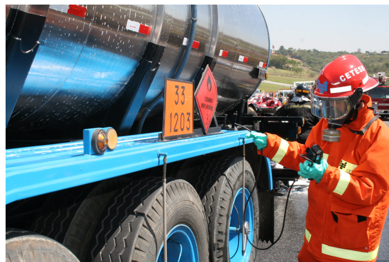
Foto 1 - monitoramento ambiental deve considerar a densidade dos gases ou vapores
