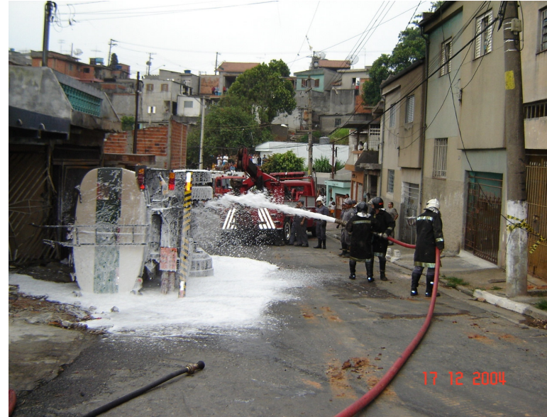
Foto 3 - abatimento de vapores em função da alta pressão de vapor do produto
