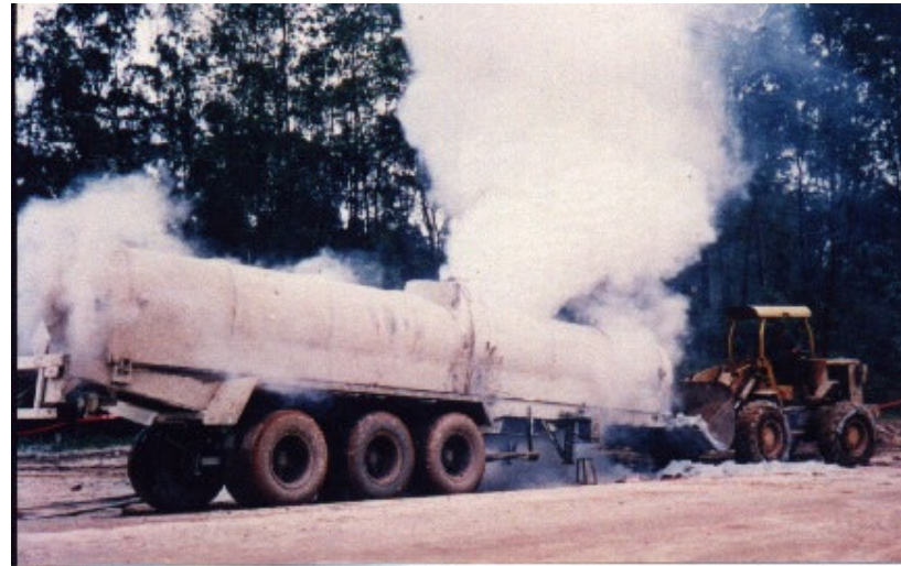
Foto 5 – Os vapores gerados na neutralização são agressivos ao homem
