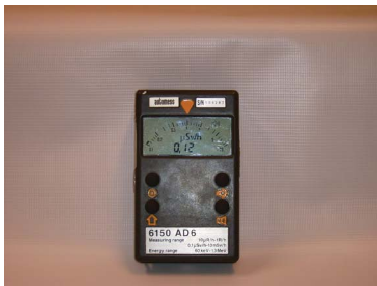
Figura 3.20: Equipamento para detecção de radioatividade.
