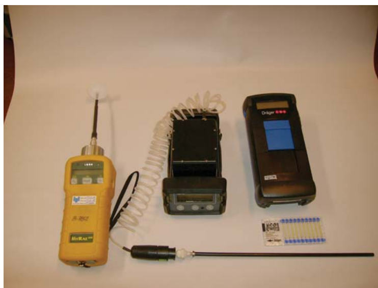
Figura 3.14: Equipamentos para detecção de gases e vapores tóxicos.
