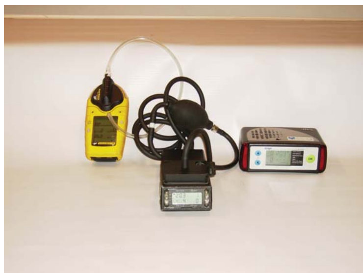
Figura 3.15: Equipamentos para detecção de gases e vapores tóxicos e inflamáveis.
