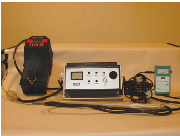
Figura 3.16: Equipamentos para detecção de gases e vapores inflamáveis e nível de oxigênio na atmosfera.
