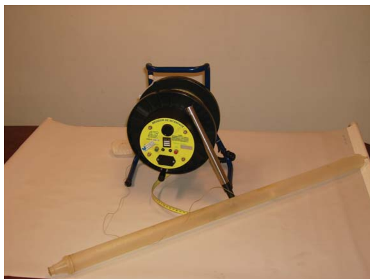
Figura 3.18: Equipamentos para medição de interface água-óleo.
