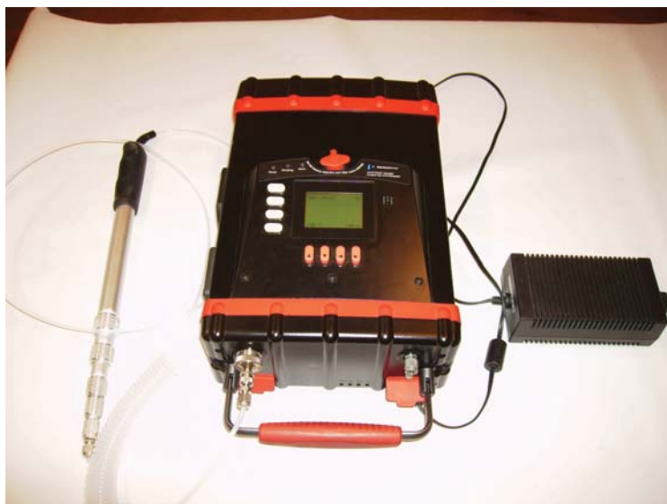
Figura 3.13: Equipamento para identificação e quantificação de produtos químicos.
