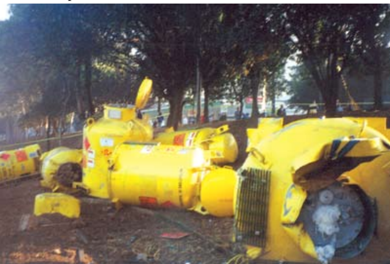
Foto 1: Do número de embalagens envolvidas no acidente, duas apresentaram vazamento pela válvula, uma delas estava posicionada no canteiro da via
