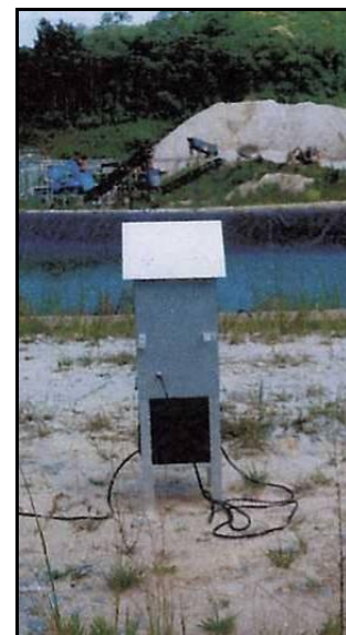
Amostrador de grandes volumes (Hi-Vol) localizado próximo à lagoa de rejeitos
