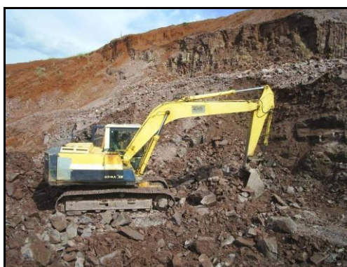
Exemplo de operação de desmonte mecânico de minério, com o emprego de retroescavadeira. Fonte: EIA Aspacar.
