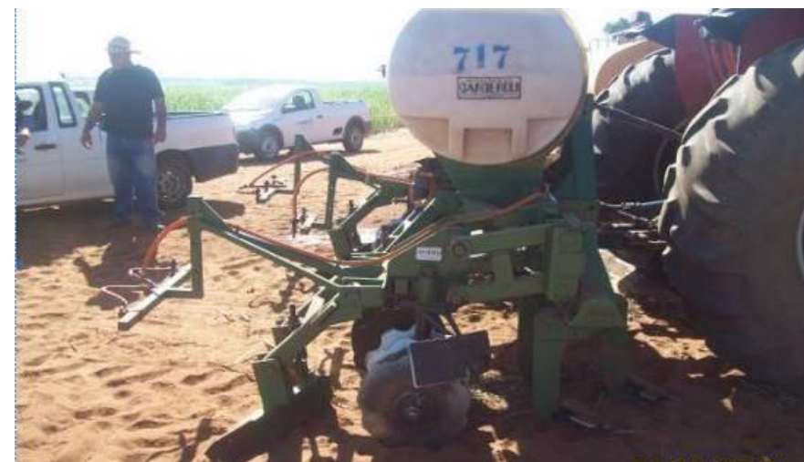
Equipamento nivelador de sulco com kit de aplicação de herbicida
