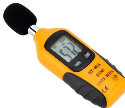
Aparelho de medição de ruído
