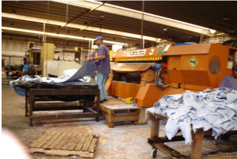
Foto 7 - Máquina da seção de rebaixadeiras – rebaixamento dos couros recém-curtidos ao cromo (“wet-blue”), para ajuste de sua espessura 4
