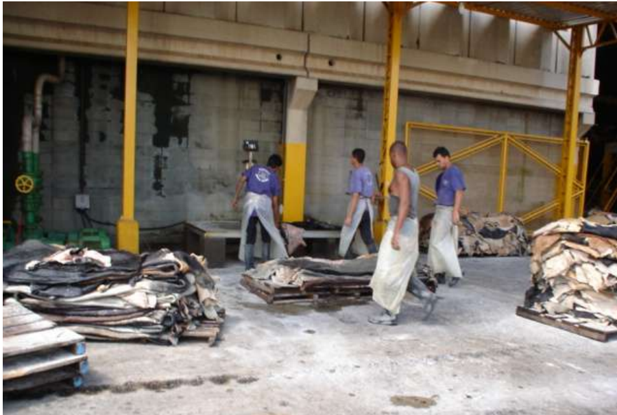
Foto 2 - Separação, pesagem e montagem dos lotes de peles para início do seu processamento (pré-remolho ou remolho) 4
