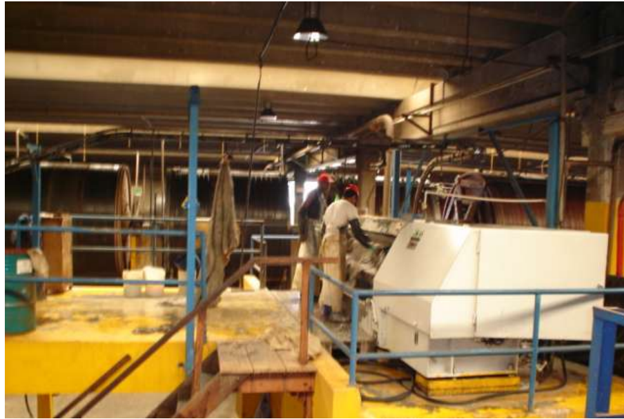
Foto 5 - Máquina descarnadeira – remoção da carnaça aderida à superfície interior ou inferior das peles 4
