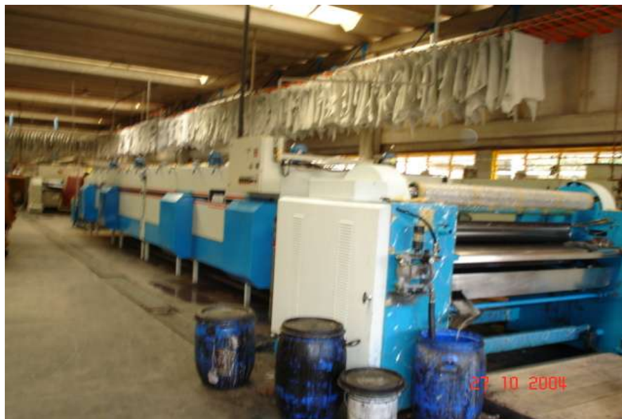
Foto 9 - Máquina da seção de acabamento – aplicação de produtos químicos à superfície dos couros 4
