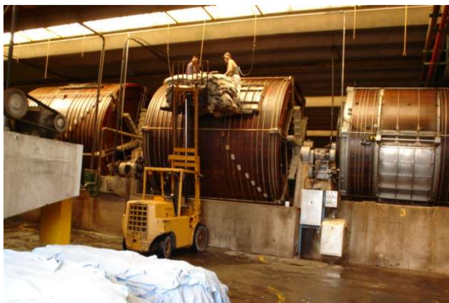
Foto 3 – Grupo de fulões - operação de carga de peles para processamento 4
