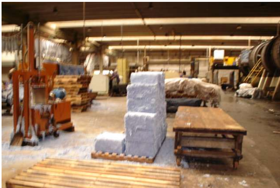
Foto 8 - Serragem / pó / farelo de rebaixadeira prensado, para armazenamento e/ou destinação posterior 4
