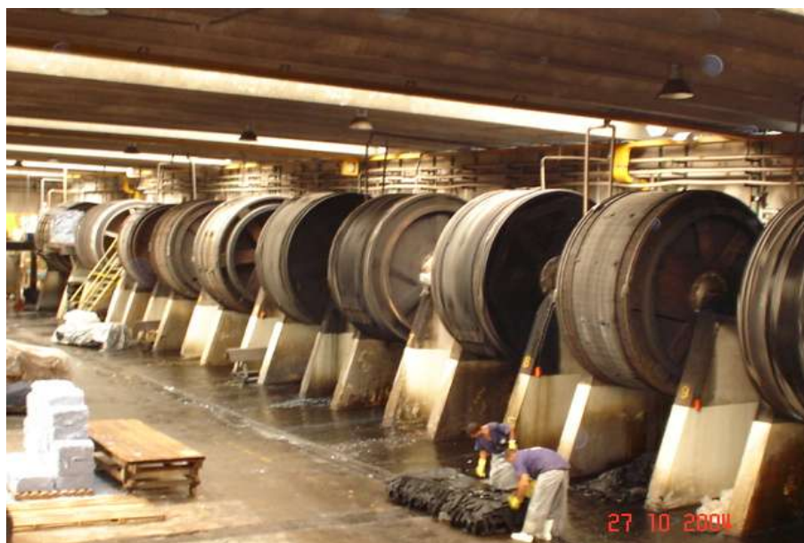
Foto 4 – Bateria de fulões e operários manuseando lote de couros recém-saído de etapa de processamento, para a seqüência das operações 4
