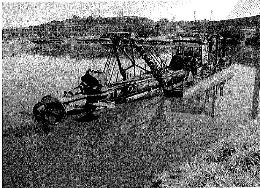
Imagem 1 – Exemplo de escarificador utilizado na calha do rio Pinheiros.
