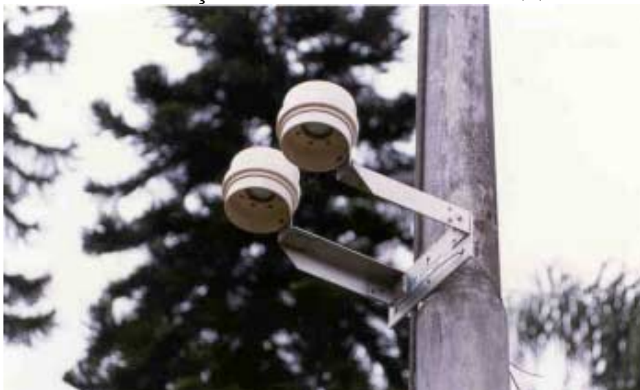
FIGURA 3 - Instalação do Amostrador Passivo EQQA
